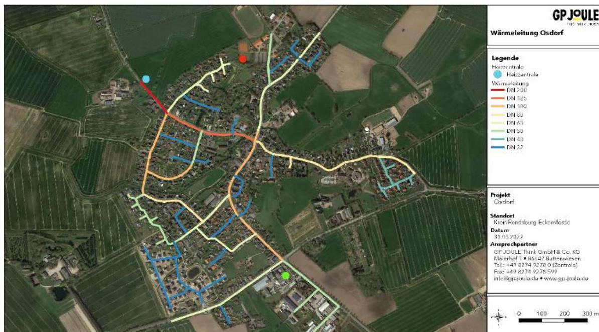
Abbildung 29: Dimensionierung eines möglichen Wärmenetzes der Gemeinde Osdorf
