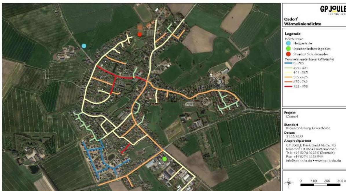
Abbildung 30: Wärmelinienendichte Osdorf bei einer Anschlussquote von 50%
